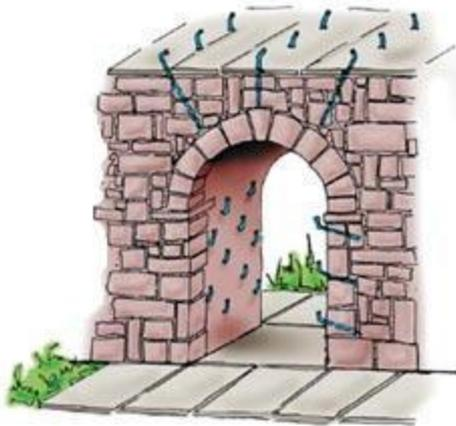
Iniezioni armate per consolidamento di una volta a botte.
